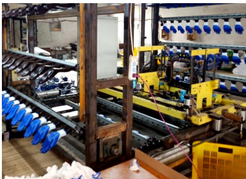
Зображення 2. Процес нанесення спіненого латексу на трикотажну рукавичку.
