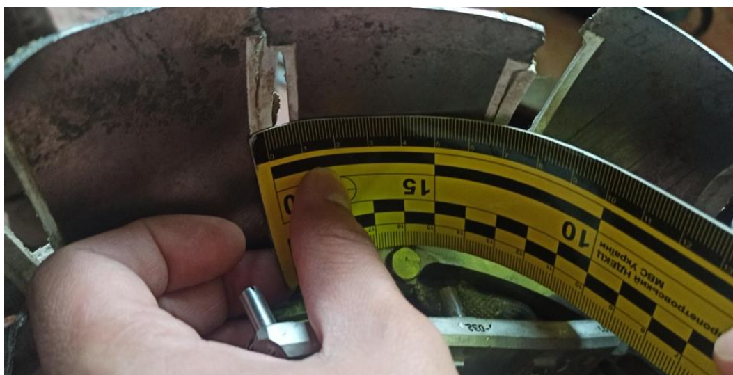
Рис. 4. Послаблений перетин шпангоуту кріплення головного обтічника до корпусу відсіку системи наведення
